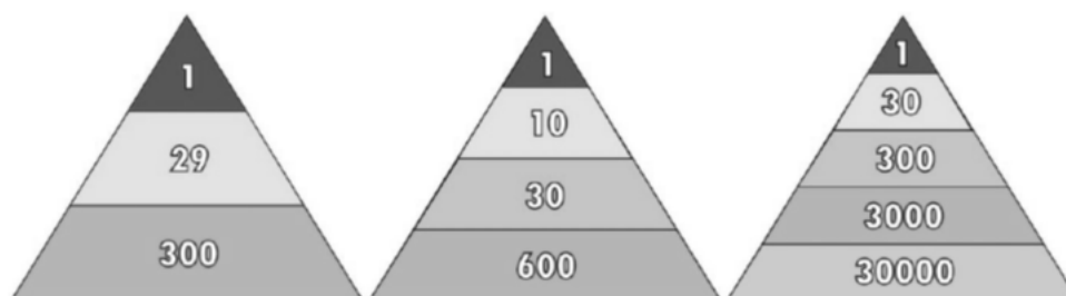
Rys. 1. Trójkąt H.W. Heinricha (po lewej) oraz jego modyfikacje wykonanej przez Birda (środek) oraz firmę ConocoPhilips Marine (po prawej) (na podstawie Heinrich H.W.: Industrial Accidents Prevention, New York, Toronto, London, Mc Graw Hill Book Company 1959)
