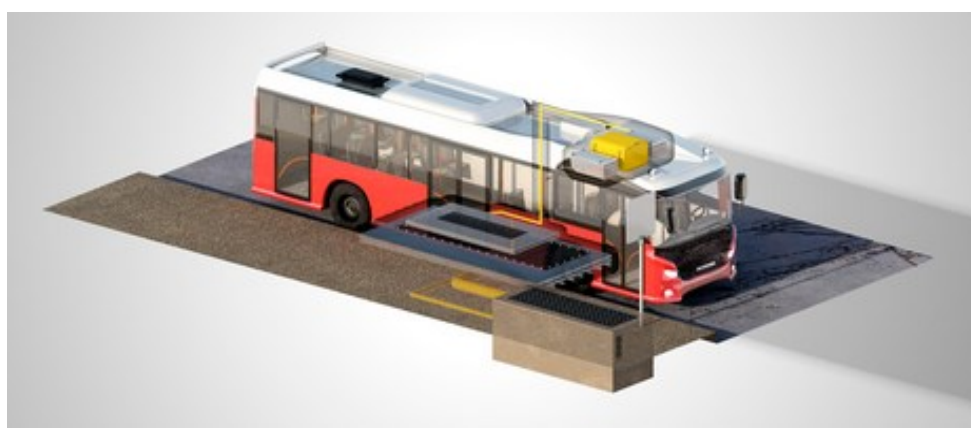
Rys. 4. Schemat ładowarki indukcyjnej oraz odbiorników prądu na pojeździe firmy Scania (www.scania.com)
