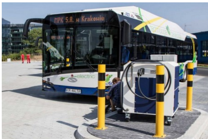
Rys. 3. Ładowarka typu plug-in w zajezdni autobusowej MPK w Krakowie (www.radiokrakow.pl)
