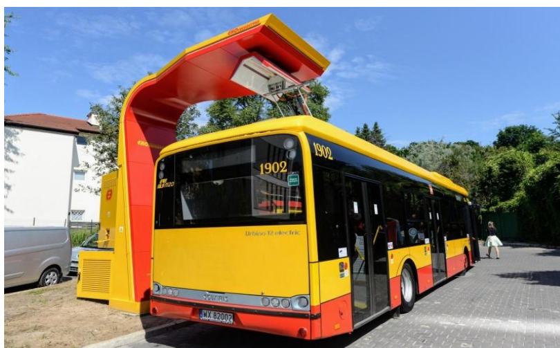
Rys. 5. Autobus elektryczny marki Solaris podczas ładowania z wykorzystaniem pantografu ( www.ztm.waw.pl )
