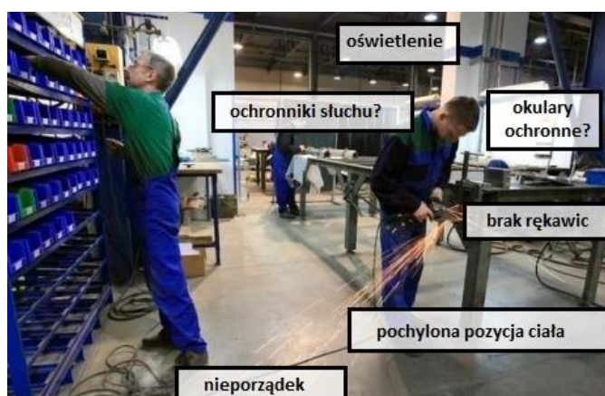
Rys. 3. Szybka wizualizacja – zagrożenia podczas pracy w hali produkcyjnej (oprac. własne na podst. [5])
